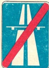
Bild 306 Ende der Autobahn
